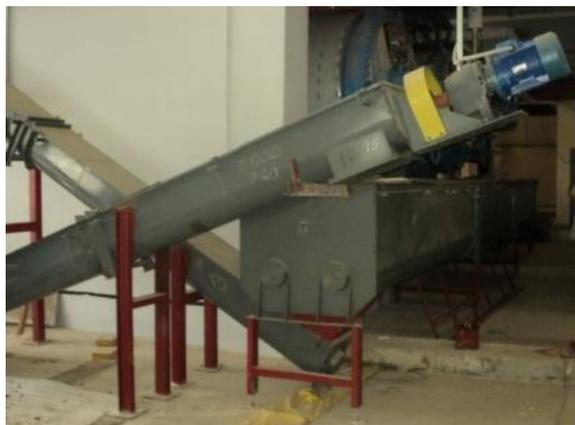
Шнековый транспортер – оборудование для перемещения сырья или готового продукта путем вращения шнека. Сырье или готовый продукт проталкивается вдоль направления спирали спирального корпуса.
