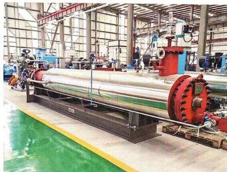
Процесс химического гидролиза (с добавлением ферментов и Q-ферментов) с дальнейшей перекачкой сырья в котел-деструктор для стерилизации и сушки продукта.
