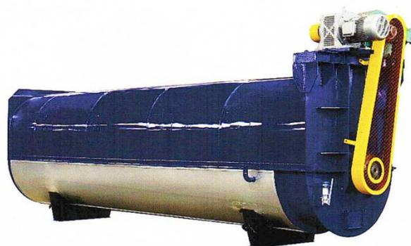
Роторная сушилка использует насыщенный водяной пар или высокотемпературное теплопроводящее масло в качестве источника тепла. Ротор для перемешивания внутри цилиндра приводится в движение электрическим двигателем. При непрерывном контакте
