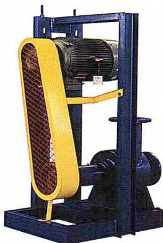
Насос при помощи всасывающего патрубка забирает перо-водяную массу из резервуара и перекачивает её на сепаратор. Это ещё один агрегат, входящий в цепочку оборудования по переработке пера. В сепараторе идёт распределение смеси на две составляющие. В итоге получают чистое перо без воды. Агрегаты для транспортировки перо-водяной смеси различаются по трём рабочим показателям:
