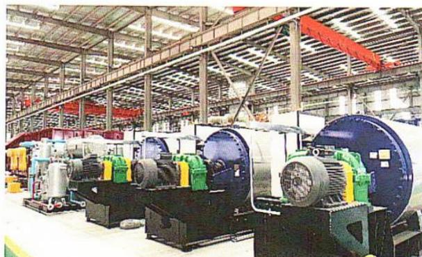
Котел представляет собой герметичный корпус, изготовленный из термостойких материалов, выдерживающих воздействие тепла и давления. Эффективность гидролиза и качество продукта обеспечивается системой контроля.
