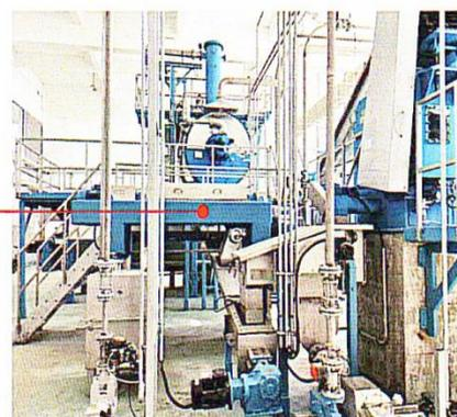
Декантер-центрифуга (декантер, горизонтальная центрифуга) – это двухфазный горизонтальный сепаратор непрерывного действия, который за счет центробежной силы, создаваемой при высокоскоростном вращении барабана, позволяет разделять суспензии на жидкость и твердый осадок. При этом очищенная жидкость отводится из барабана декантера самотеком, а твердый осадок удаляется с помощью встроенного в барабан шнека.
