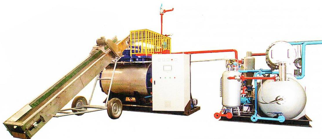
Модульная компактная установка рассчитана для переработки небольших объемов биологических отходов, характеризуется небольшими размерами, простотой эксплуатации, автоматизированным управлением и высокой эффективностью. Обработка сырья производится под высоким давлением при высокой температуре.
