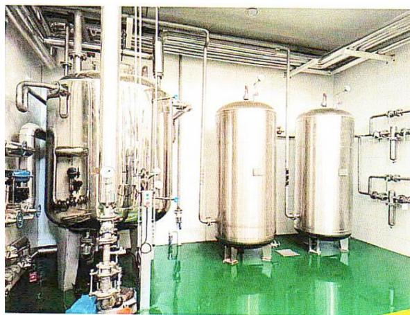
Выполнена из антикоррозийных материалов (углеродистая сталь, нержавеющая сталь), выбор объема зависит от производственной мощности. Готовые резервуары оснащены системой контроля нагрева и охлаждения.
