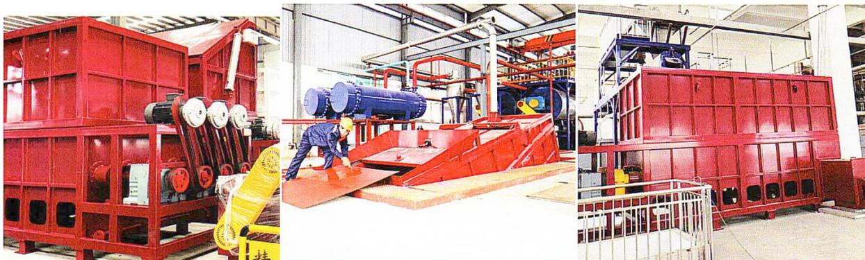
Предназначен для временного хранения мясокостных непищевых отходов, биологических отходов в приемном отделении цехов утилизации.
