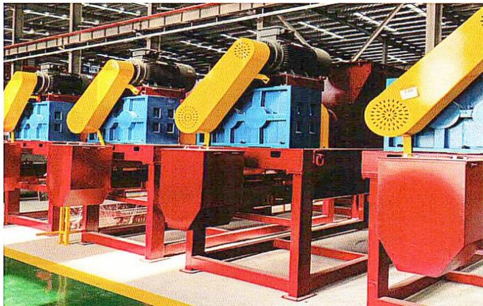
Измельчитель предназначен для измельчения мясокостного сырья.
