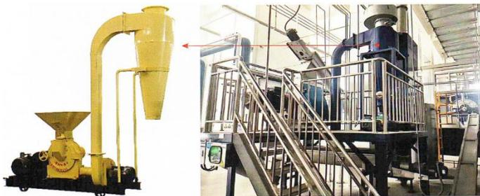
При попадании обезжиренной шквары (муки) в дробилку через загрузочный патрубок или рукав, внутри корпуса происходит дробление частиц. Измельченная шква (мука) просыпается сквозь сито и выдувается в выгрузной
