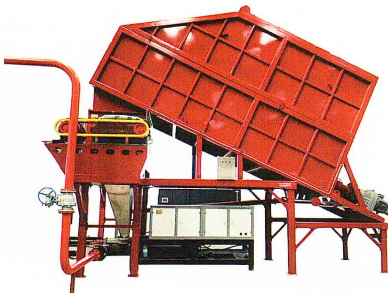
Сырье после загрузки бункера измельчается до размера менее 5 см и подается для дальнейшей переработки насосной системой. Конструкция оснащена системой самоочистки и дезинфекции, процесс происходит в закрытом режиме, что предотвращает распространение бактерий.
