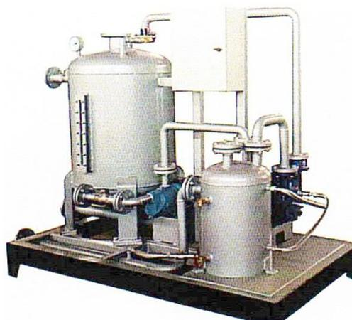
Вакуумная насосная станция используется для создания и поддержания вакуумной среды в системе оборудования, состоящей из насосов, клапанов, трубопроводов, контрольно-измерительных приборов и систем управления. Ее основная функция заключается в откачке воздуха из основного оборудования с целью снижения давления воздуха и ускорения испарения воды.
